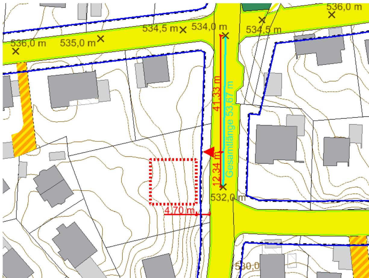
Abb. 2: Beispielhafte Darstellung zur Ermittlung der Bezugsgeländehöhe eines Gebäudes (Baukörper rot gestrichelt) durch Interpolation an der Grundstückszufahrt (rotes Dreieck)
